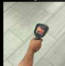
Verificare la presenza di perdite nell'impianto di riscaldamento radiante
